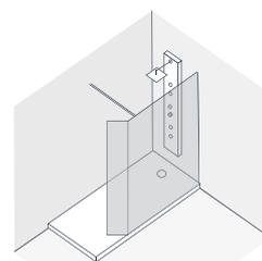
One fixed leaf and one folding | Une lame fixe et une pliante | Una hoja fija y una batiente
